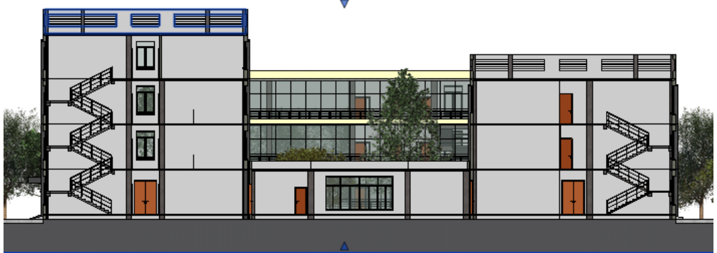
图 3.8 楼梯 Revit 模型剖面视图
