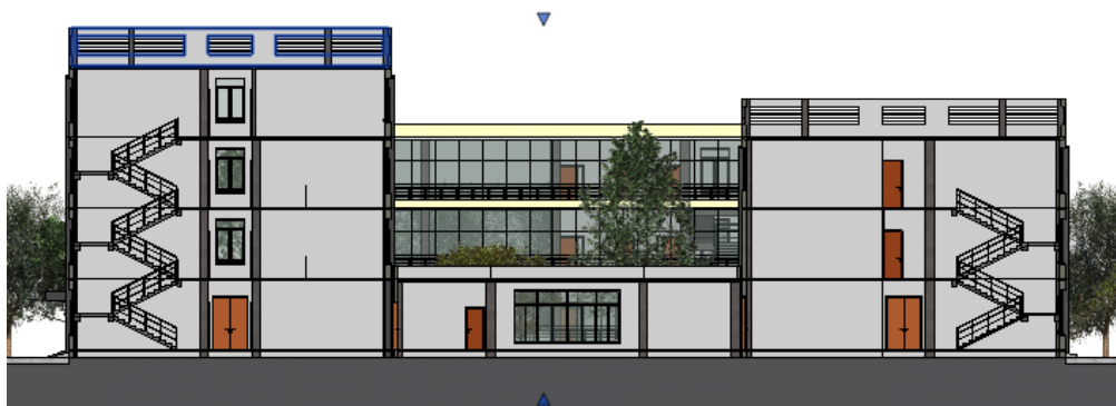
图 2.3 楼梯 Revit 模型剖面视图
